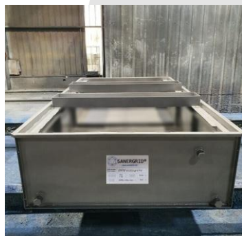
Protection galvanique des bacs métalliques
