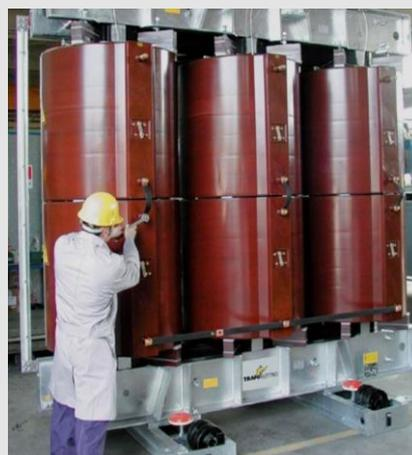
Transformateur sec spécial 4 MVA bi tension 15/20 kV
