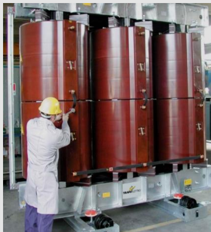
Transformateur sec spécial 4 MVA bi tension 15/20 kV
