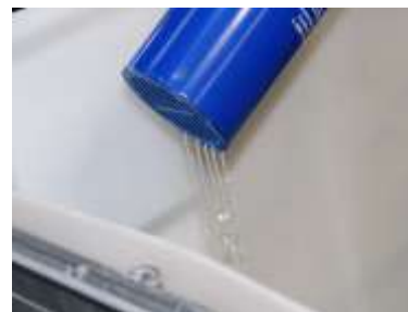
Etat de fonctionnement normal du filtre : la matière active laisse passer l'eau
