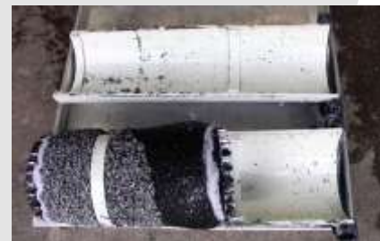
Exemple d'un PETRO PIPE saturé en hydrocarbures, coupé en deux montrant la matière active ayant formé un bouchon
