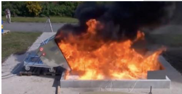
Exemple de test en laboratoire d'une couverture coupe-feu EXTICOV-LHD® sur fosse de récupération.
