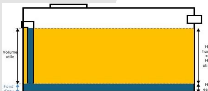
Figure 4 : Fonctionnement d'urgence : fuite complète de 100% du volume d'huile, retenu dans la DEPOSIT®
