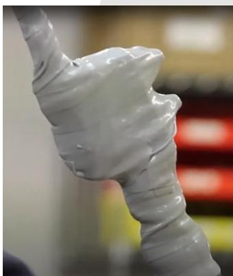
Le ruban en silicone auto-fusionnant d'épaisseur 0,8 mm crée une barrière isolante sur mesure et offre un classement d'isolation de 15 kV phase à terre avec un seul enroulement et de 30 kV avec un double enroulement. Il est adapté pour être installé sur des équipements présentant des formes irrégulières.
