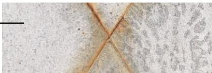
En cas de dommages profonds jusqu'au substrat (Acier dans ce cas), la zone sera protégée et limitée à un oxyde de fer léger. La rouille ne se développera pas et ne se propagera pas sous la galvanisation.
